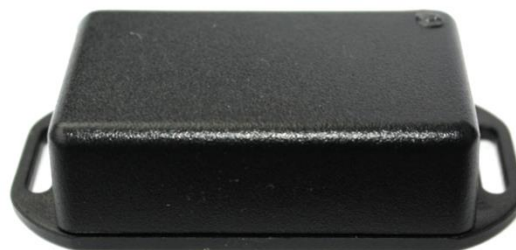
Bilde av radiomottaker til RM2 (monteres utenfor sikringskap)
